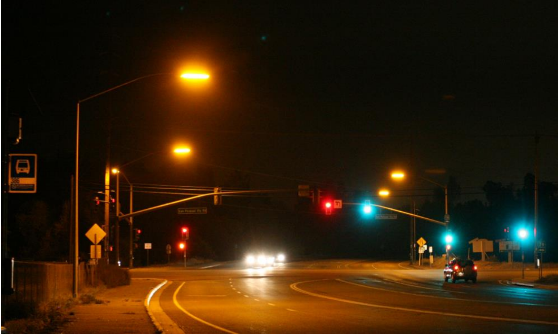
شكل رقم ٥٨: إضاءة الشارع عن طريق مصباح صوديوم ذو ضغط منخفض
