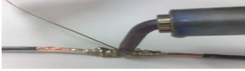
شكل رقم ١٤٧: لحام الوصلة العدلة.
