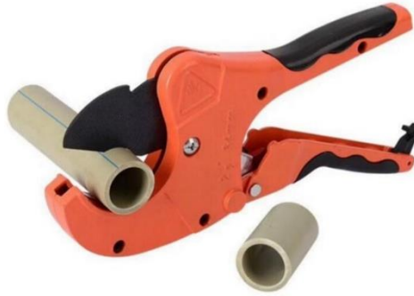
شكل رقم ١١٥: مسكين قطع المواسير البلاستيك PVC
