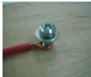
شكل رقم ١٣٤: وصلة بعروة مثبتة في مسمار
