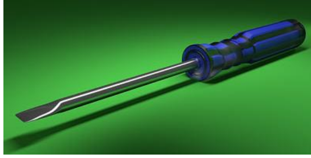
شكل رقم ٩: المفك العادة (المبسط) Slotted Screwdriver
